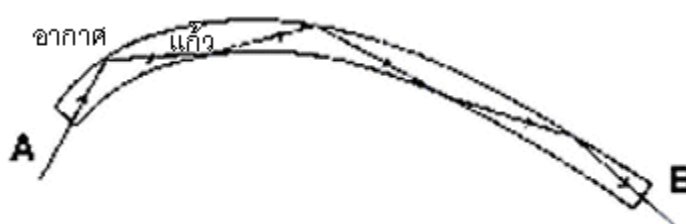
ภาพที่ ๔-๗ เส้นทางของแสงในสายไฟเบอร์ออปติก
