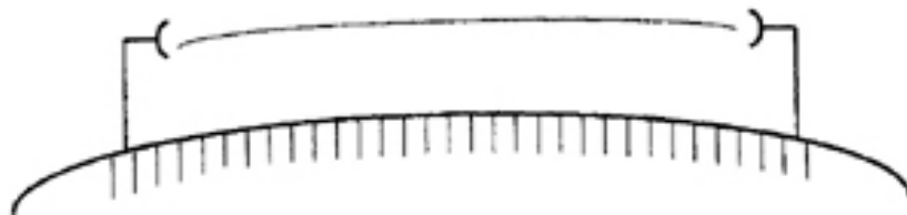
ภาพที่ ๒-๔๕ แสดง แนวทางการเคลื่อนที่ของคลื่นในลักษณะ Line of Sight
