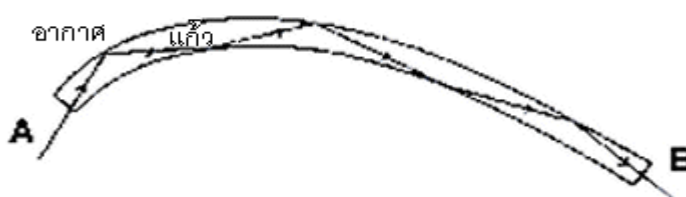
ภาพที่ ๑๒-๖ การเดินทางของแสงในสายไฟเบอร์ออฟติก
