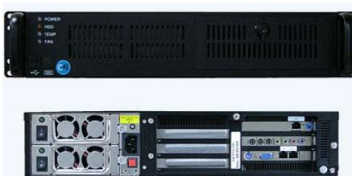
ภาพที่ ๒-๖๔ Communication Server Unit (CSU)
