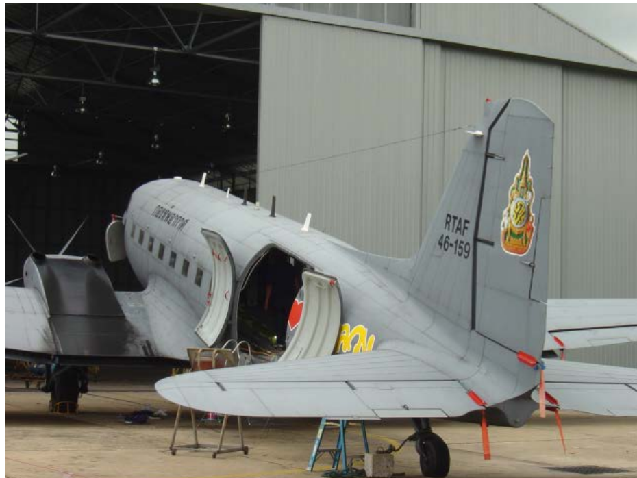
ภาพที่ ๕ - ๒ บ. BT-67 ติดตั้งอุปกรณ์ ส-๑. ซึ่งมีเสาอากาศติดตั้งอยู่บน บ.
