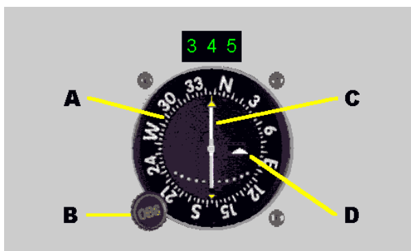
ภาพที่ ๒-๒๔ หน้าปัด แสดงข้อมูลของ VOR บนเครื่องบิน ที่มา : http://www.navfltsm.addr.com/vor-nav.htm
