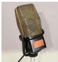
ภาพที่ ๒-๒๗ ริปบอนไมโครโฟน (Ribbon Microphone)
