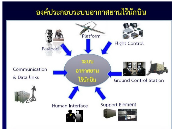
ภาพที่ ๑-๒๐ แสดง องค์ประกอบของระบบอากาศยานไร้คนขับ (UAV)
