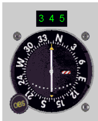
ภาพที่ ๒-๒๗ การแสดงผลระบบ VOR ใช้งานไม่ได้
