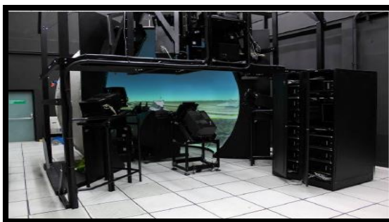
ภาพที่ ๑-๑๐ แสดง ระบบเครื่องฝึกบินจำลอง F-16 FSS
