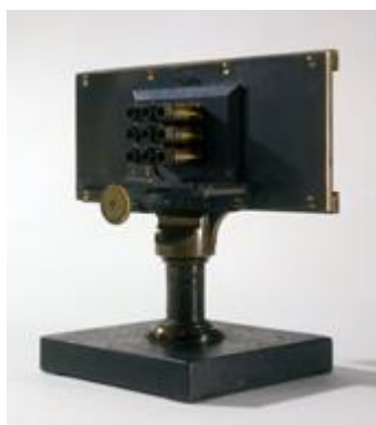
ภาพที่ ๓-๒๐ แสดง กล้องถ่ายภาพสำหรับผลิตภาพขนาดเล็ก (Microphotography Camera)
