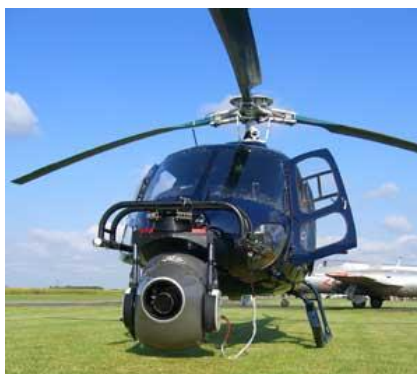
ภาพที่ ๓-๑๕ แสดง กล้องถ่ายรูปทางอากาศ (Aerial Camera)
