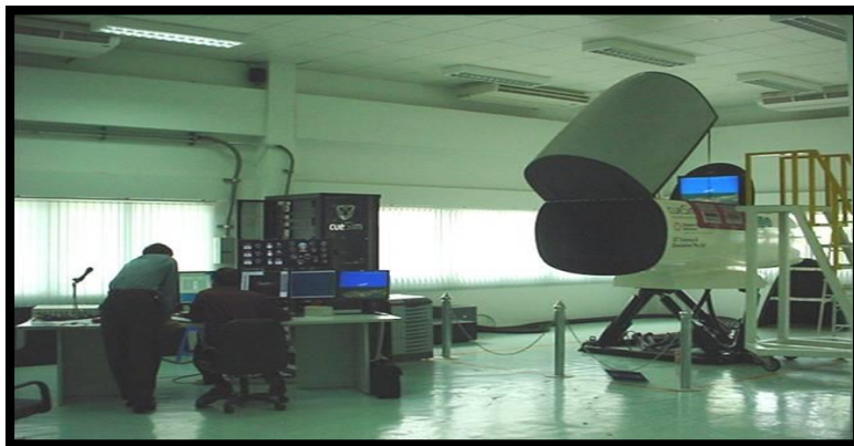
ภาพที่ ๑-๑๕ แสดง ระบบเครื่องฝึกบินจำลอง L-39 EFS
