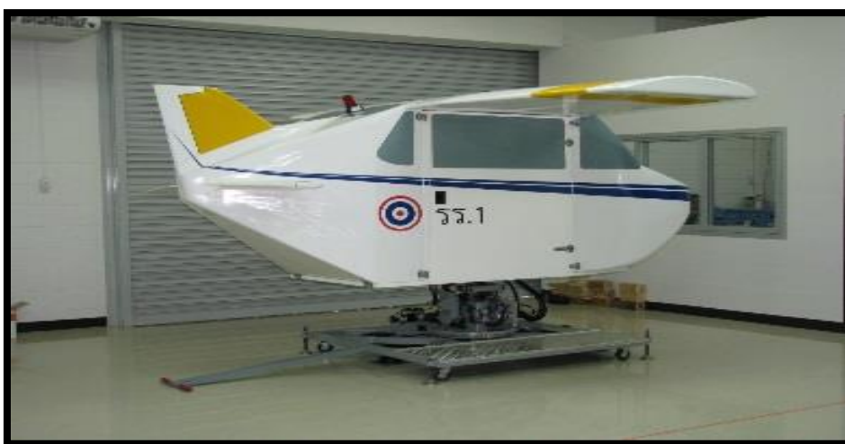
ภาพที่ ๑-๑๒ แสดง ระบบเครื่องฝึกบินจำลอง GAT II CPT
