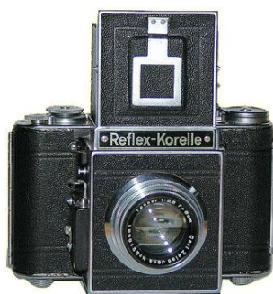
ภาพที่ ๓-๘ แสดง แบบเลนส์เดี่ยว (Single Len Reflex)
