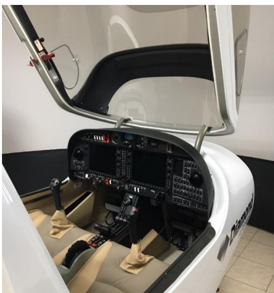
ภาพที่ ๑-๑๘ แสดง ระบบเครื่องฝึกบินจำลอง DA-40TH
