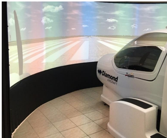
ภาพที่ ๑-๑๑ แสดง ระบบเครื่องฝึกบินจำลอง DA-42TH
