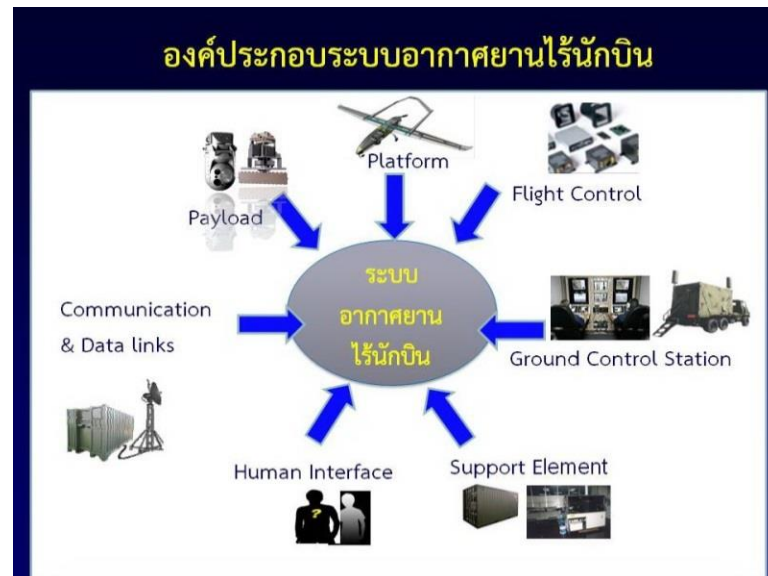
ภาพที่ ๑-๒๕ แสดง องค์ประกอบของระบบอากาศยานไร้คนขับ (UAV)
