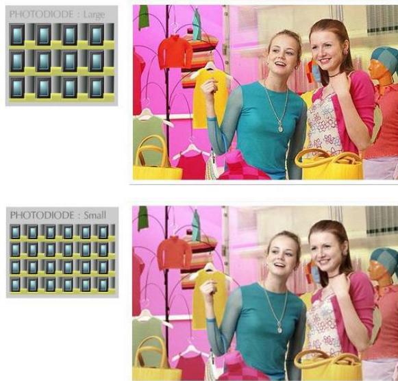
ภาพที่ ๓-๓๔ แสดงการเปรียบเทียบขนาดของ PHOTOSITE ที่มีผลต่อคุณภาพของภาพที่
