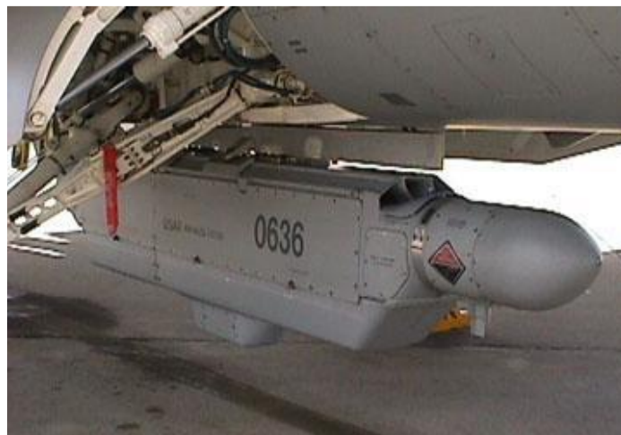
ภาพที่ ๒-๒๑ แสดง AN/ALQ-131 Self Protection Jammer Pod
