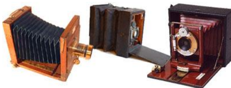
ภาพที่ ๓-๖ แสดง กล้องพับ (Folding Camera)
