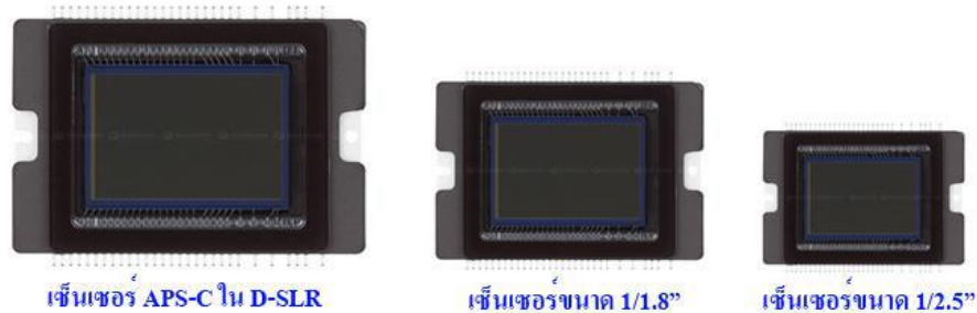
ภาพที่ ๓-๓๓ แสดง เซนเซอร์ในขนาดต่างๆ
