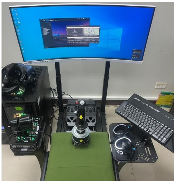
ภาพที่ ๑-๑๙ แสดง ระบบการฝึกบินจำลองด้วยแว่น 3 มิติ
